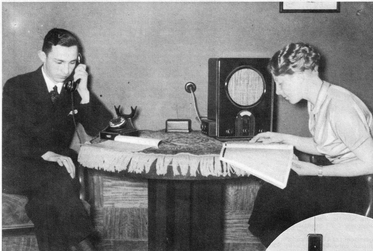
Der hochfrequente Drahtfunk erlaubt gleichzeitig Rundfunk zu hören und zu telefonieren. Unter Bild zeigt einen Drahtfunk-Anschluß mit angeschaltetem Volksempfänger. Rechts im Kreis: Die notwendige zusätzliche Einrichtung, die nur in einem kleinen Kästchen und in einer Steckdose besteht, läßt sich überall leicht anbringen.
